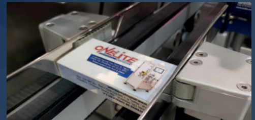
Separador de estuches automático
