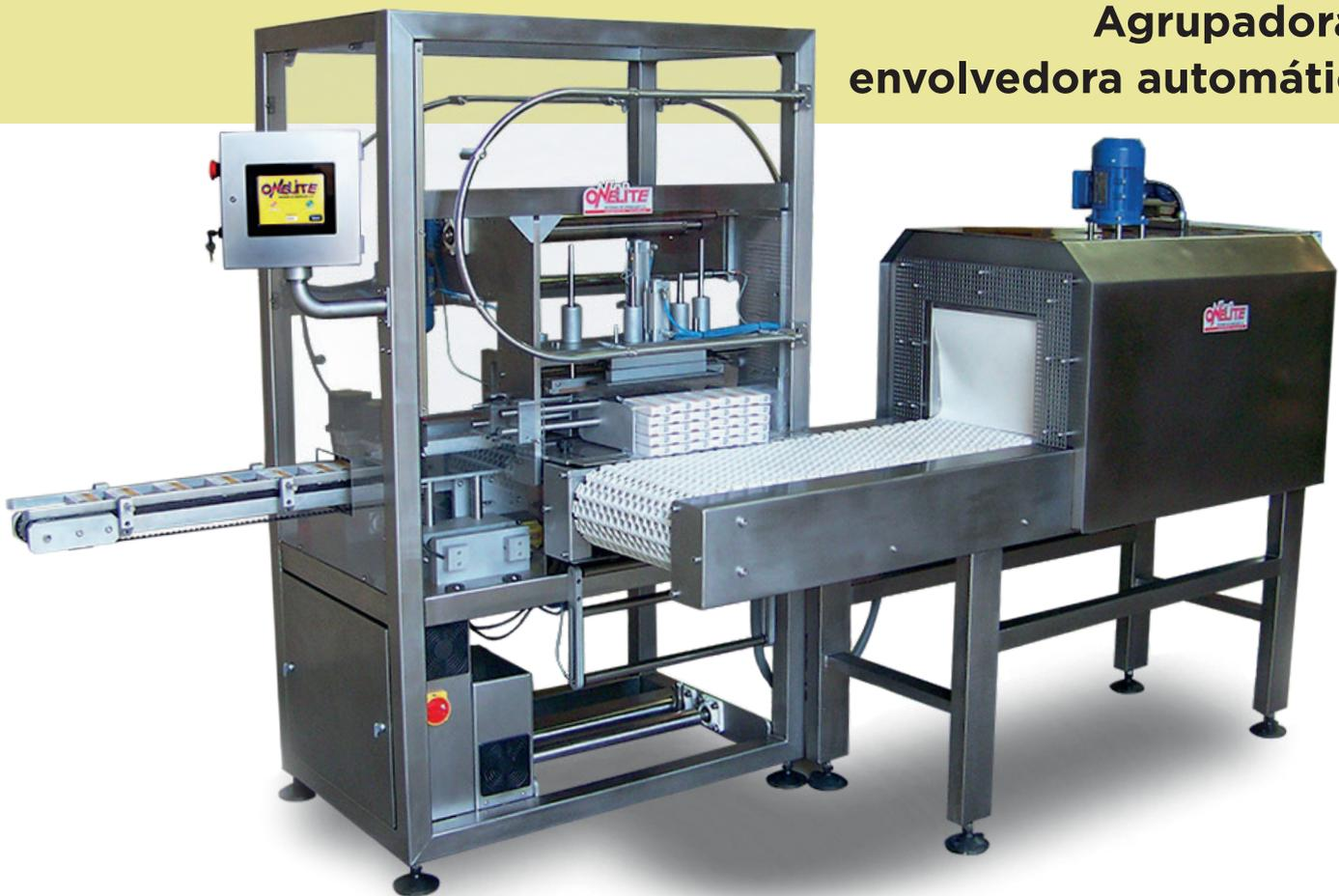
Permite agrupar estuches de manera horizontal, apilarlos y luego envolverlos formando el pack. Dos únicas regulaciones con indicador numérico de posición para un fácil y rápido ajuste. PLC con CFR 21, panel táctil de 7 pulgadas con interfaz amigable con el operador.
